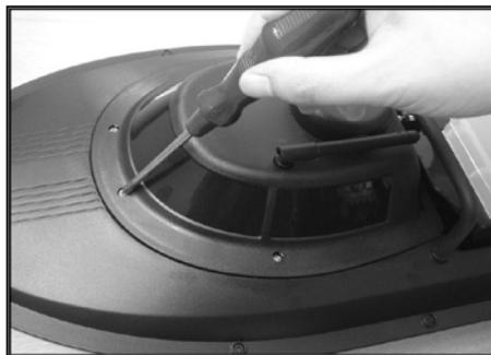
5. Установите водонепроницаемое кольцо и закрепите верхнюю крышку с помощью винтов.
